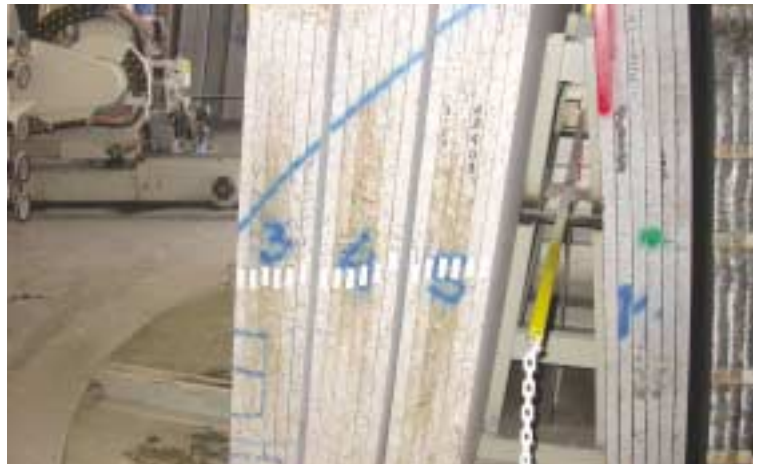
Su ogni lastra viene applicato un transponder Rfid dello spessore di 16 mm, inferiore a quello della lastra stessa
