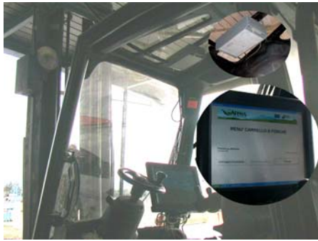
Computer e reader RFID a bordo del muletto
